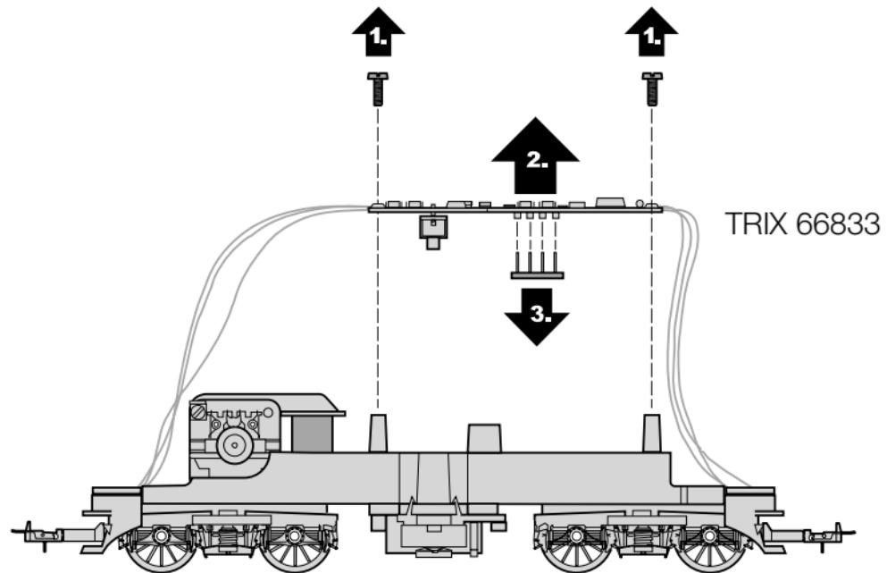
Einbau selectrix Fahrzeug-Decoder
