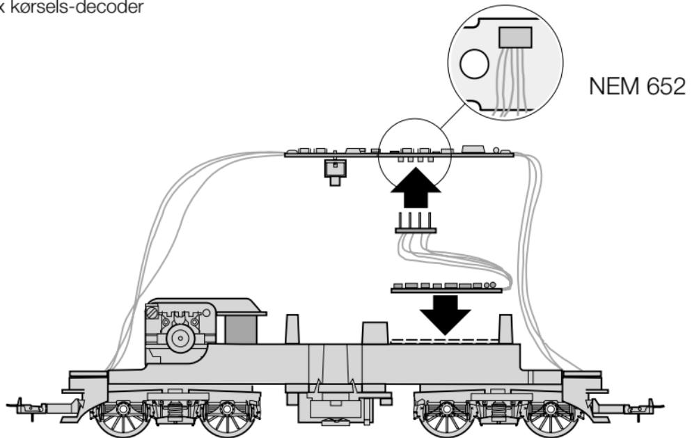
Trix Triebfahrzeuge dürfen auf Digitalanlagen nicht ohne eingebauten Lokdecoder betrieben werden (Beschädigung des Motors möglich!).
