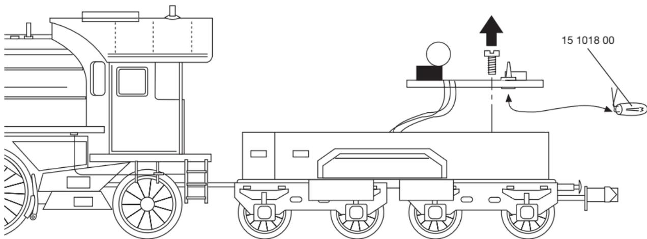
Einbau des Lok-Decoders mit der schwarzen Verguss-
