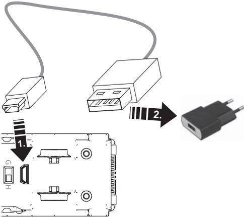
Mit beiliegendem Kabel beträgt die Ladezeit ca. 3 Stunden.
