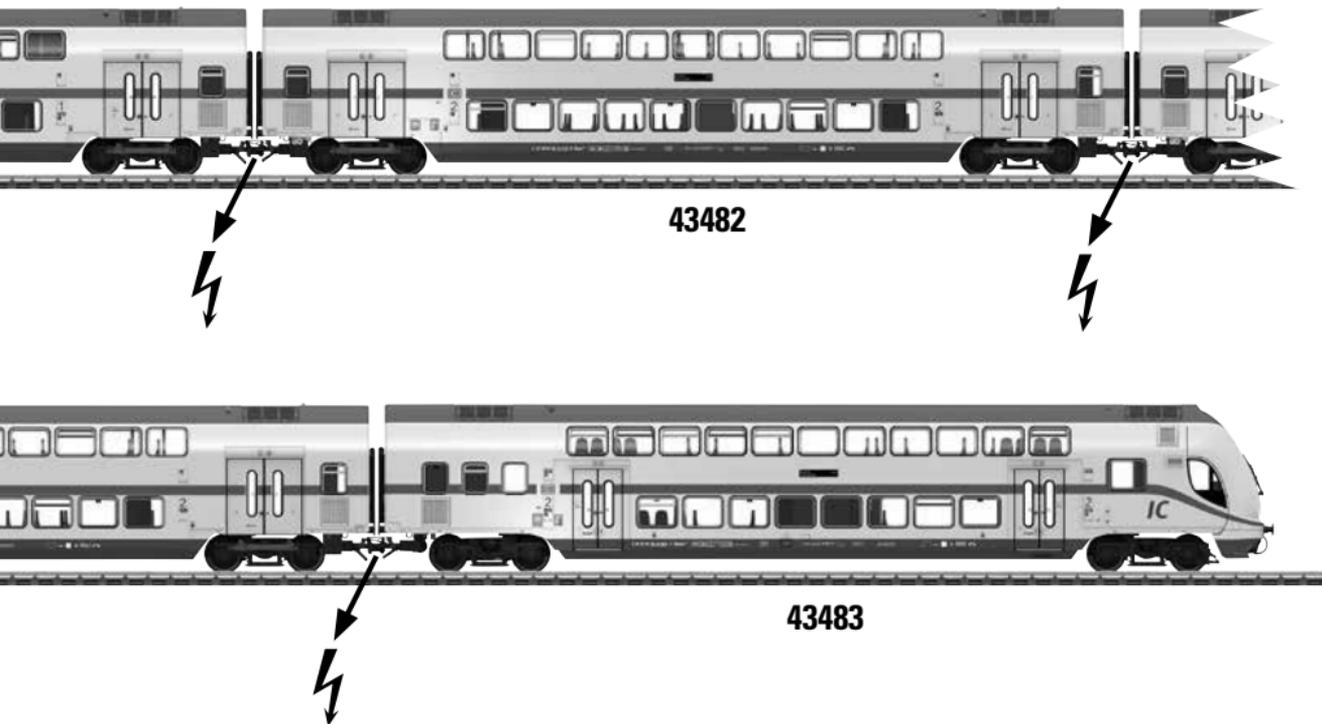
⚡ = stromführende Kupplung; current-conducting couplers; Accouplements conducteurs; Spanninggeleidende koppelingen; Conductoresde corrente; Conduttori di corrente; Strömledande kopplen; Stromforende koblinger
