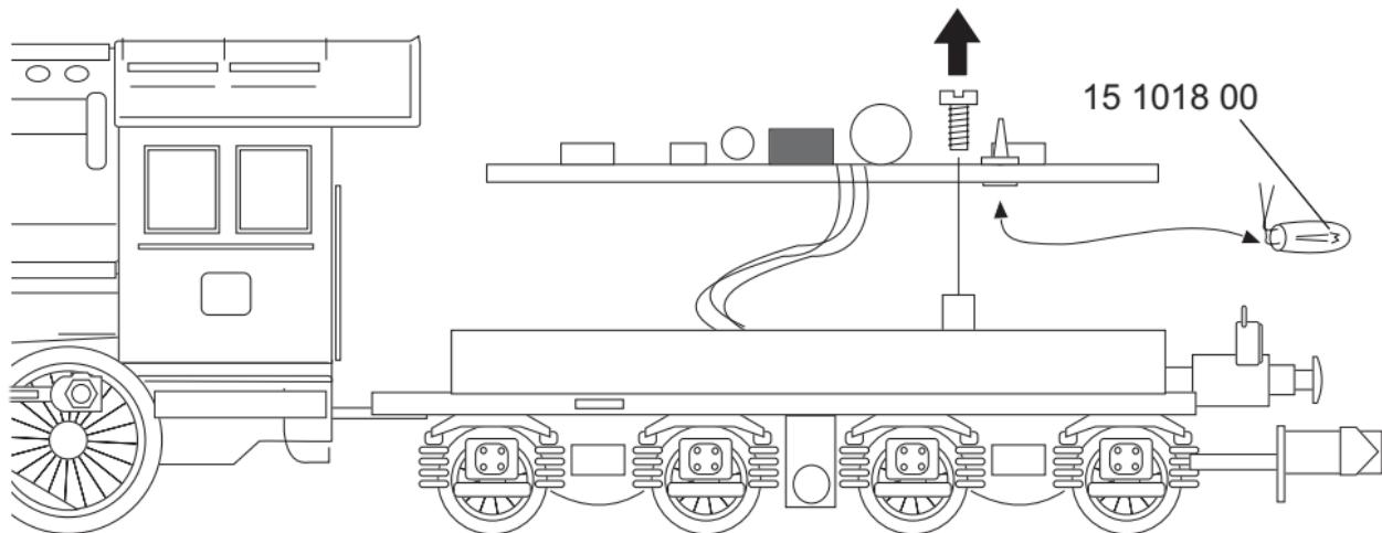
Einbau des Lok-Decoders mit der schwarzen Vergussmasse nach oben.
