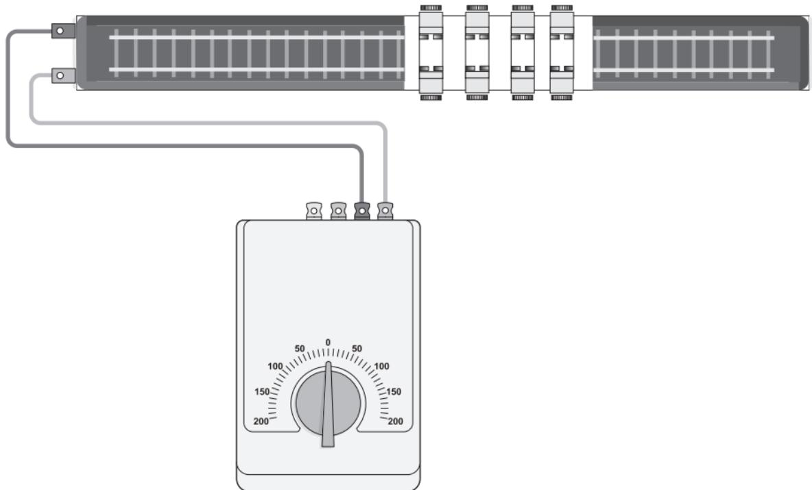
Anschluss an eine Selectrix-Zentrale
