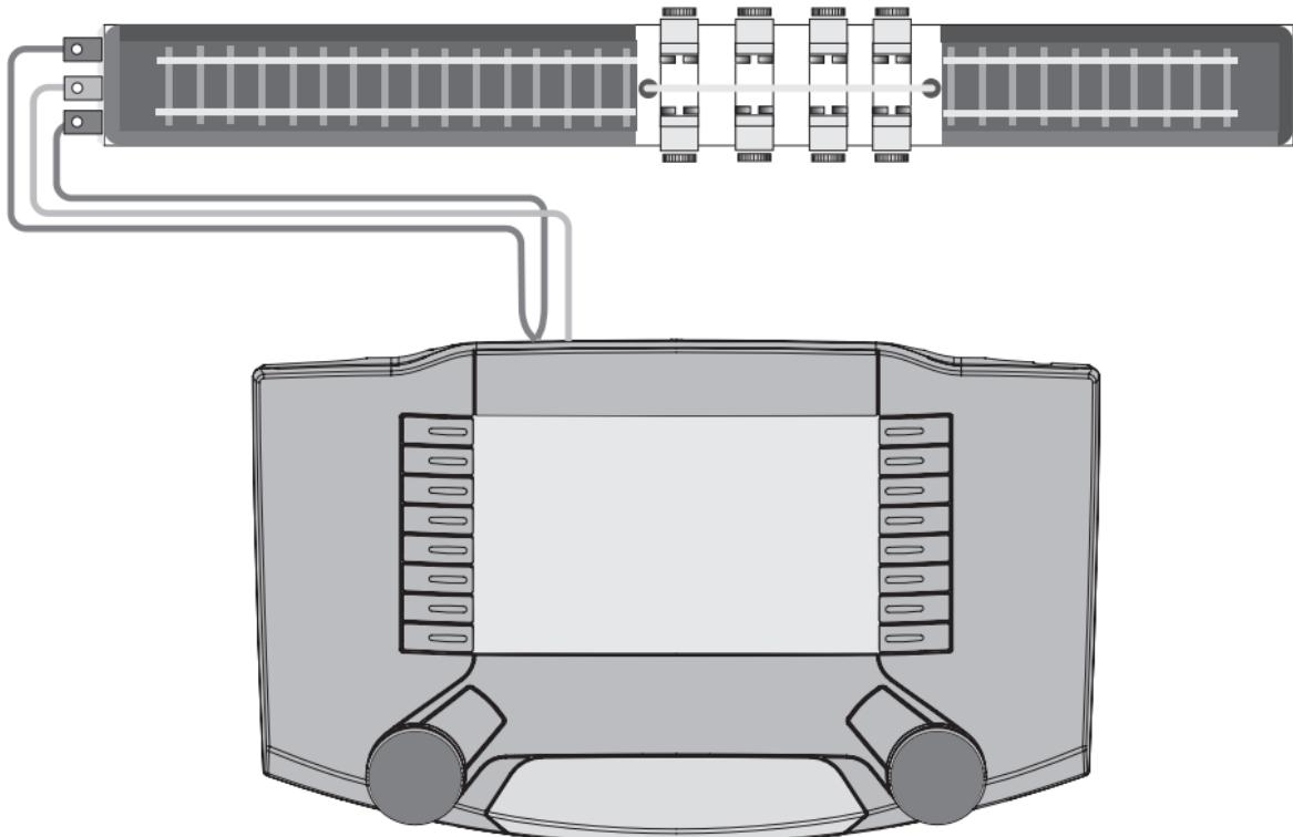
Anschluss eines Gleichstrom-Fahrgeräts, Zweischiernenbetrieb
