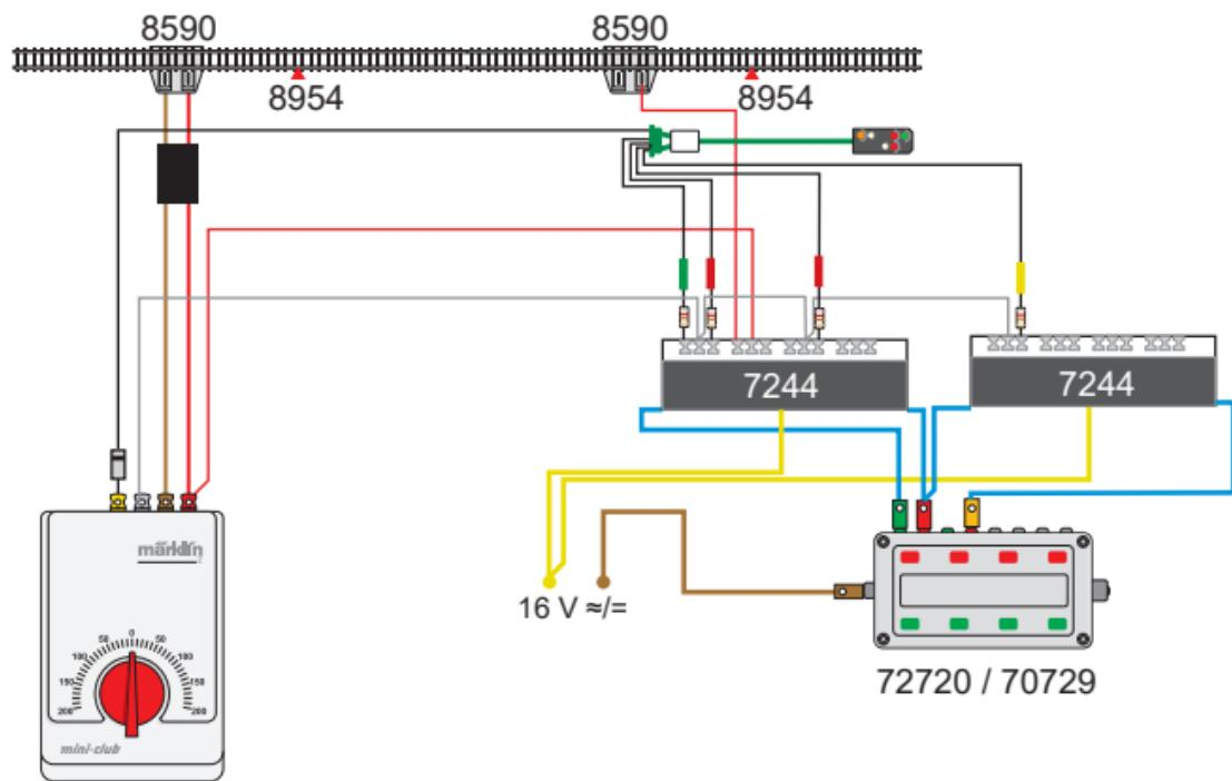
**Anschluss des Signals 89393 (Hp00, Hp0+Sh1, Hp1, Hp2)**
