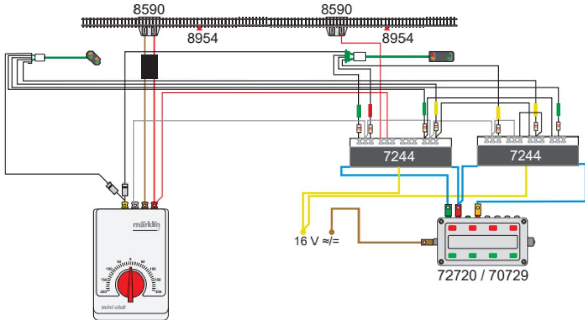
**Anschluss des Signals 89393 + 89390 (Hp00, Hp1, Hp2)**
