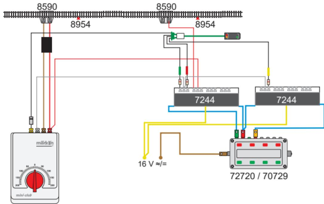
**Anschluss des Signals 89393 (Hp00, Hp1, Hp2)**
