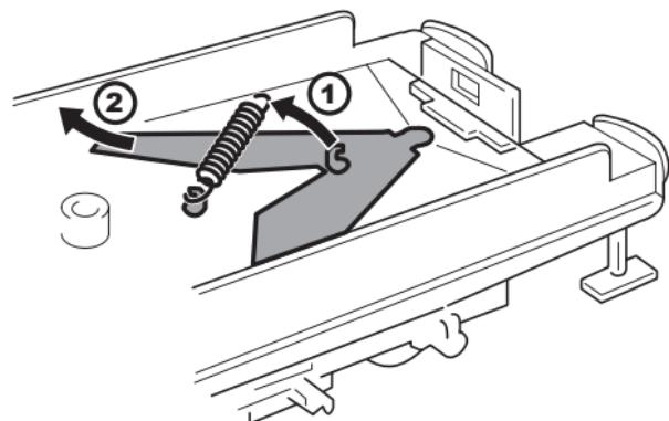
Neue Kupplungsdeichsel (mit Kontaktfeder) einbauen.
