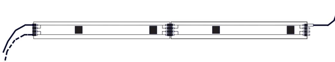
Anschluss der Innenbeleuchtung 73400 / 73401 an Wagen mit Schleifer.
