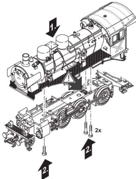
Das Zahnrad vom Getriebeteil im Lokgehäuse muss einwandfrei ins Getriebe vom Fahrgestell greifen. Zwischen Aufbau und Fahrgestell darf sich kein Spalt bilden. Gehäuseschrauben nie mit Gewalt festschrauben! Sie können sonst das Getriebe beschädigen.
