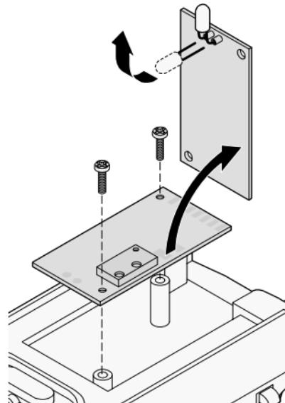
Vorbereitet zum Einbau von Lokdecodern mit NEM (M) Schnittstelle.
