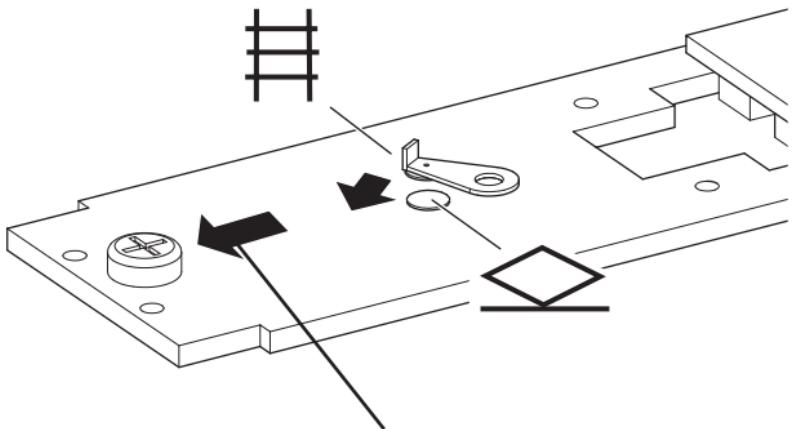
Gehäuse-Einbaurichtung Führerstand 1
