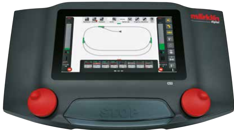
60216/60226 Central Station, Märklin-Digital-Multiprotokoll-Steuergerät Central Station, Märklin Digital multiple protocol controller Central Station, Appareil de commande Märklin-Digital multiprotocolaire Central Station, Märklin-Digital-multiprotocol-regelapparaat
