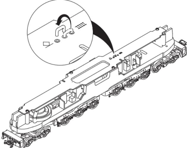
Zum Betrieb unter einer Oberleitung, die im Zick-Zack oder im Bogen verspannt ist, kann ein breiteres Schleifstück für die Stromabnehmer erforderlich sein. Aufsatz ist als Einzelteil erhältlich: 231 802
