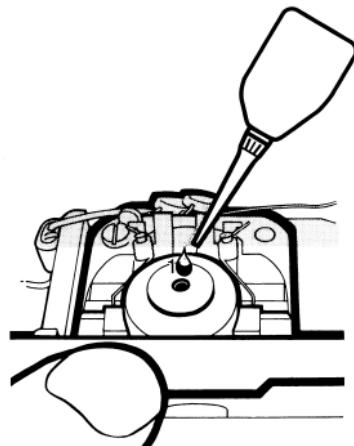
Lüfter-Antrieb nur bei Bedarf leicht ölen
