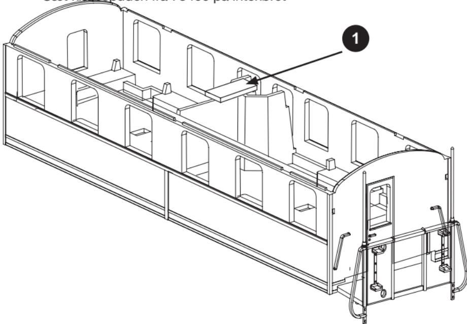
**2** Beim Fixieren der Leiterplatte auf dem Klebekissen beachten, dass keine LED's abgedeckt werden!
