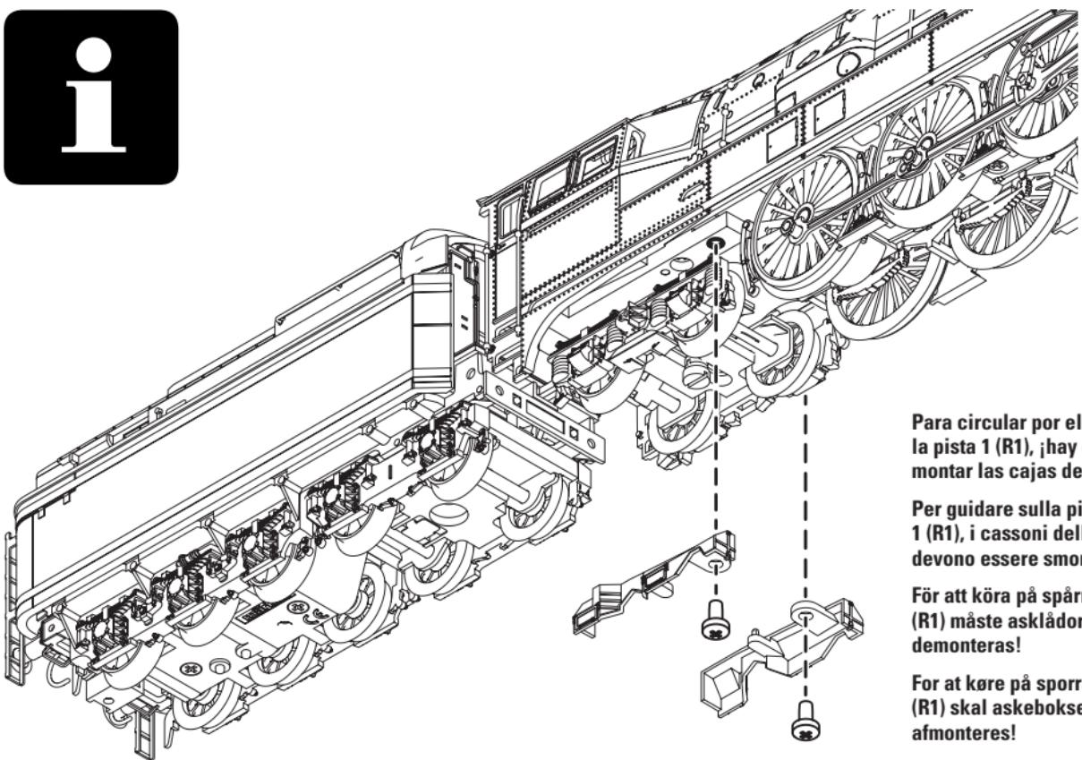
Para circular por el radio de la pista 1 (R1), ¡hay que desmontar las cajas de cenizas!
