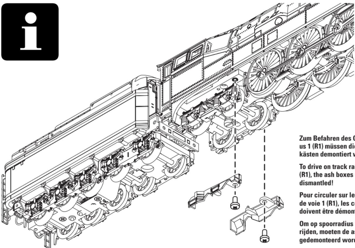
**Zum Befahren des Gleisradius 1 (R1) müssen die Asche-kästen demontiert werden!**
